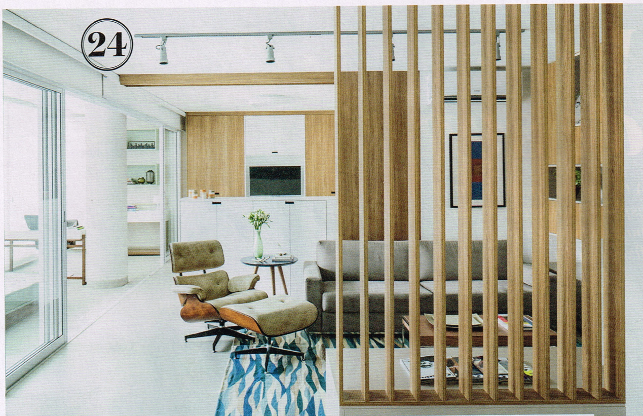
24. Para não ter de alterar demais a rede elétrica, novos pontos de luz entraram em cena por meio de trilhos com spots (Yamamura) fixados no forro de gesso existente. 25. A divisão entre os espaços ocorre de duas maneiras: a meia altura, a cabeceira de MDF com melamina branca faz as vezes de criado-mudo no quarto e armário na sala. 26. Quando é preciso isolar o ambiente íntimo, basta puxar as portas deslizantes do mesmo MDF padrão Carvalho Hanover (Duratex) usado em toda a sala.
